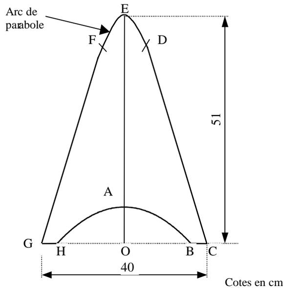
Le piètement est symétrique par rapport à l'axe (AE). FED et HAB sont des arcs de parabole.
