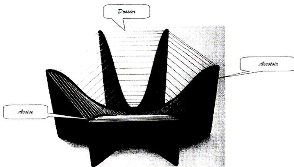
La fabrication étant prévue sur une machine à commande numérique, il est nécessaire de connaître le modèle mathématique de chacun des éléments : dossier, assise, accotoirs.
