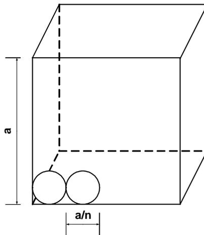
Les variables sont définies sur le schéma. Une couche contient  $n^2$  sphères ; on a  $n$  couches, il y a donc  $n^3$  sphères dans le cube. Volume d'une sphère  $V_S = \frac{4}{3}\pi\left(\frac{a}{2n}\right)^3$  d'où le volume des sphères :
