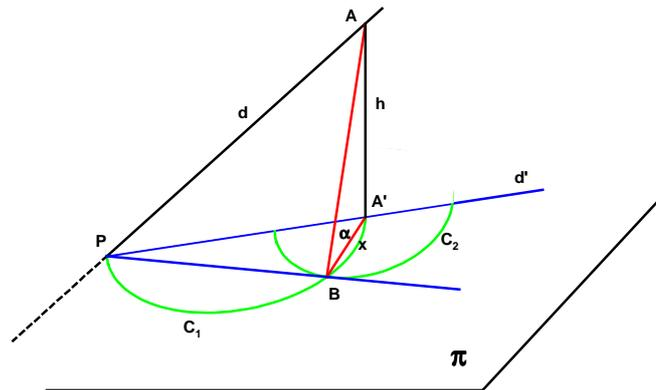
Soit  $\pi$  la face du dièdre. La droite donnée  $d$  perce  $\pi$  en  $P$ . Soit  $A'$  la projection orthogonale de  $A$ , point quelconque de  $d$  et  $AA' = h$ .
