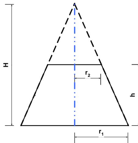
Les variables sont d\^efinies sur le sch\^ema. On a  $h = 4(r_1 - r_2)$  ; le volume des sph\^eres  $V_1 = \frac{4}{3} \pi r_1^3$  et
