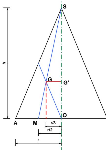
Les variables sont définies sur le schéma. Le triangle générateur est le triangle  $AOS$  ; surface  $S_{\Delta} = \frac{rH}{2}$  ;
