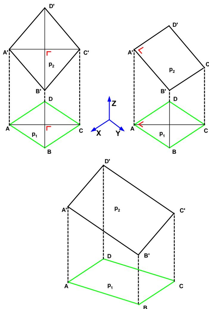
On sait que pour qu'un angle droit se conserve par projection orthogonale sur un plan, il faut qu'un de ses côtés soit parallèle à ce plan.
