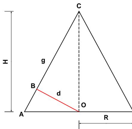
Les variables sont définies sur le schéma. On a : volume du cône  $V = \frac{1}{3}\pi R^2 H$ , aire latérale du cône :
