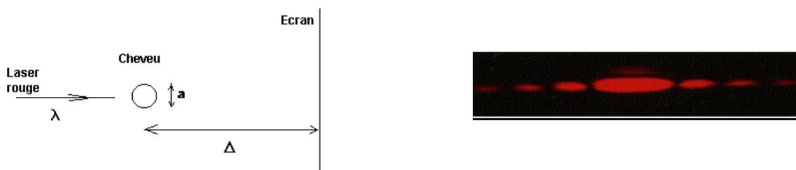
La distance  $\Delta$  entre les fils et l'écran, doit rester constante (environ 5 m).
