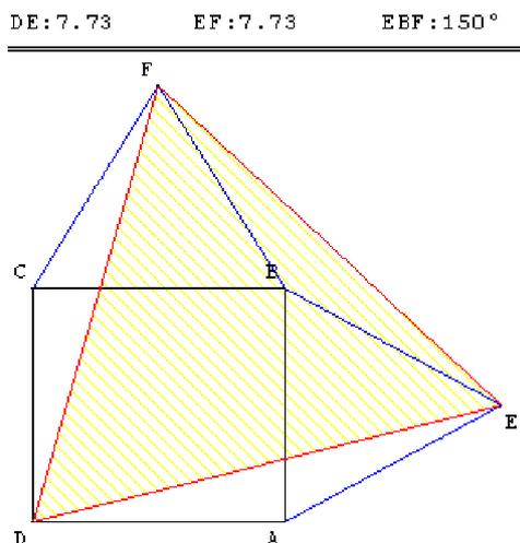
Sur deux côtés consécutifs d'un carré  $ABCD$ , on construit extérieurement à celui-ci deux triangles équilatéraux  $ABE$  et  $BCF$ . Le triangle  $DEF$  ainsi formé est équilatéral.
