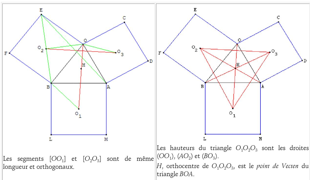
En examinant la figure ci-dessus à gauche, on voit que la similitude  $S\left(B, \sqrt{2}, \frac{\pi}{4}\right)$  transforme le triangle  $OBO_1$  en  $EBA$  et la similitude  $S\left(O, \sqrt{2}, -\frac{\pi}{4}\right)$  transforme le triangle  $O_3BO_2$  en  $AOE$ . En composant la similitude de centre  $B$  suivie de la réciproque de la similitude de centre  $O$  on a :
