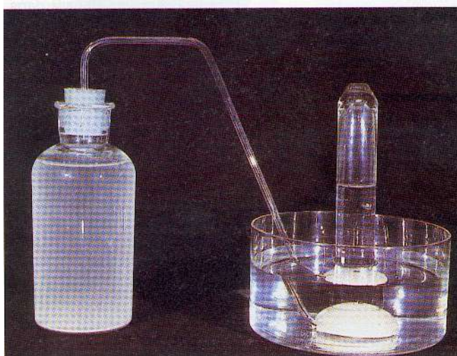
Montage d'expérience de la fermentation alcoolique.
